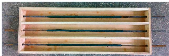
Рис. 7.5. Общий вид опалубки и армирования образцов для испытаний на центральное растяжение
