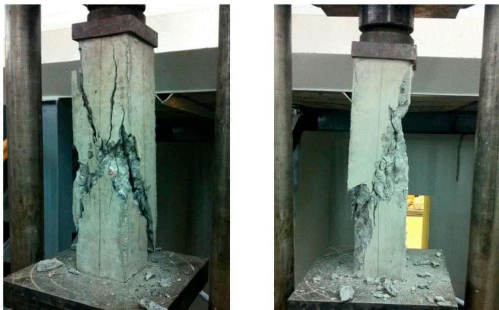
Рис. 7.9. Разрушение бетонных призм
