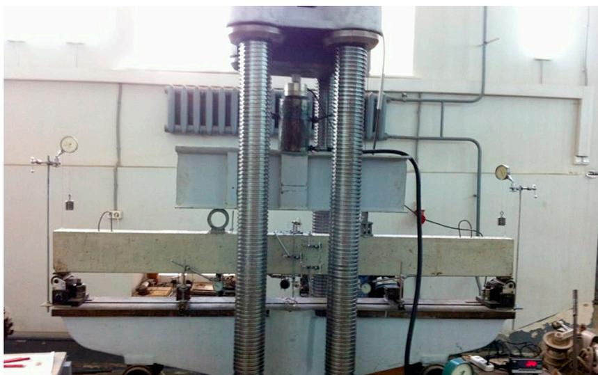
Рис. 7.24. Общий вид железобетонного образца на установке для испытания на изгиб
