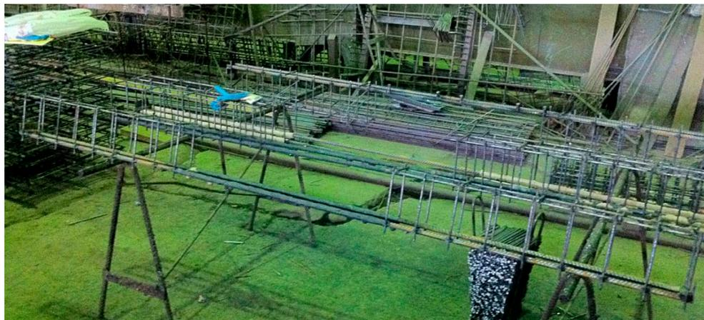
Рис. 7.2. Общий вид каркасов для экспериментальных образцов с нарушенным сцеплением
