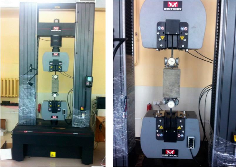
Рис. 7.11. Общий вид образца в испытательной системе INSTRON 5989
